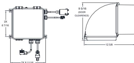
EXTERNAL CABLE FOR THE WALL MOUNT CONFIGURATION IS ONLY 6 FEET LONG BOX ONLY SHOWN, 317829
